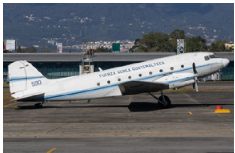
Guatemala Air Force DC-3: Aus dem Jahr 1945 stammt diese DC-3 aus den Beständen der Luftwaffe Guatemalas, die 1990 mit neuen Triebwerken zur Basler Turbo DC-3 umgebaut wurde. Foto: Gerrit Griem
